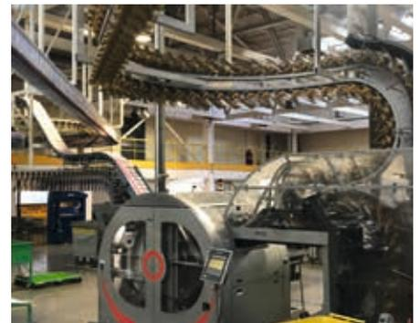
Das hochauflagige Supplement „Sun TV Magazine“ wird statt als in Folie verpacktes Bündel neu dank EasySert von Ferag mit eingesteckten Beilagen in die Tageszeitung „The Sun“ integriert.
