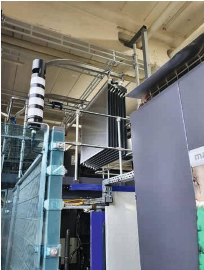
Druckplatten in Gondel auf der Schiene.
